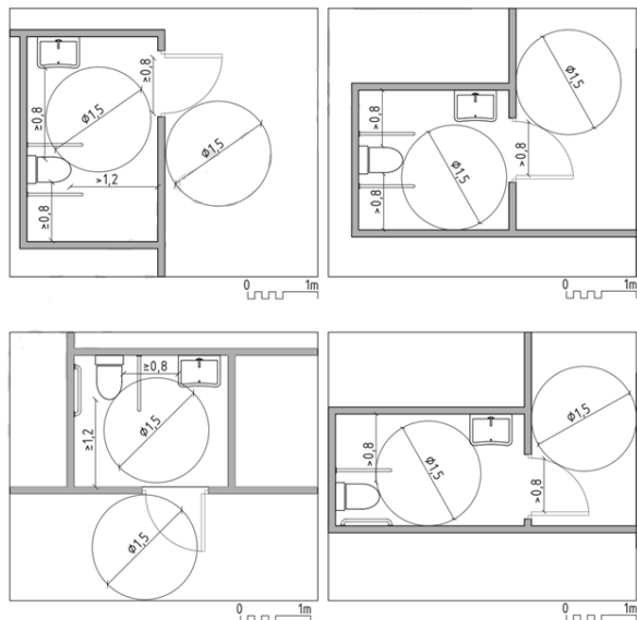
Фиг. 78. Примерни решения за достъпна тоалетна
