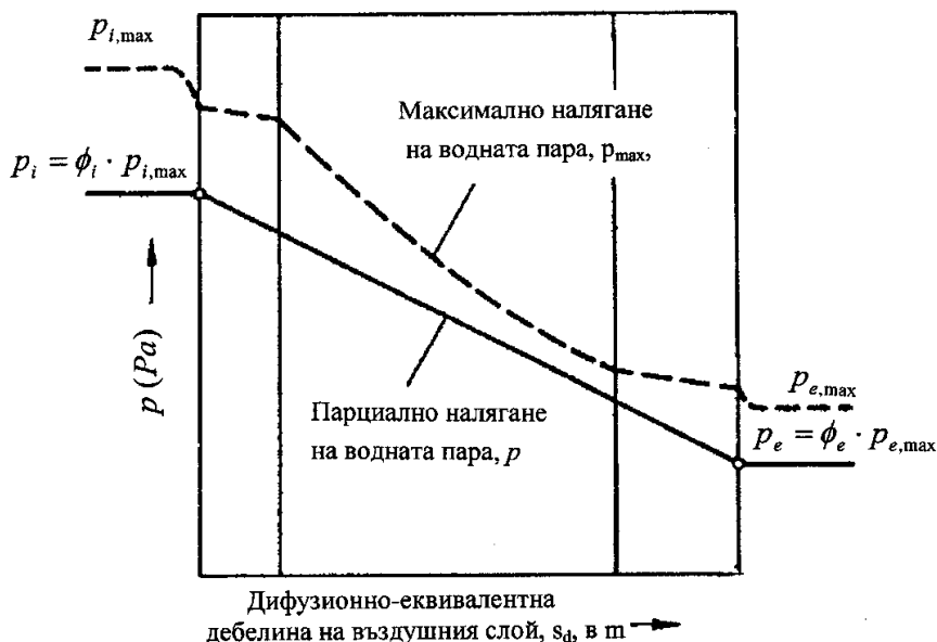
Фиг. 2.2. Схема на максималното и парциалното налягане през многослойна ограждаща конструкция или елемент, съответстващи на температурата, за изчисляване на евентуален кондензационен пад
